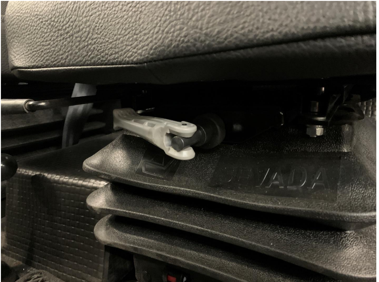
Рисунок 3.5 – Регулировка жесткости сиденья.
