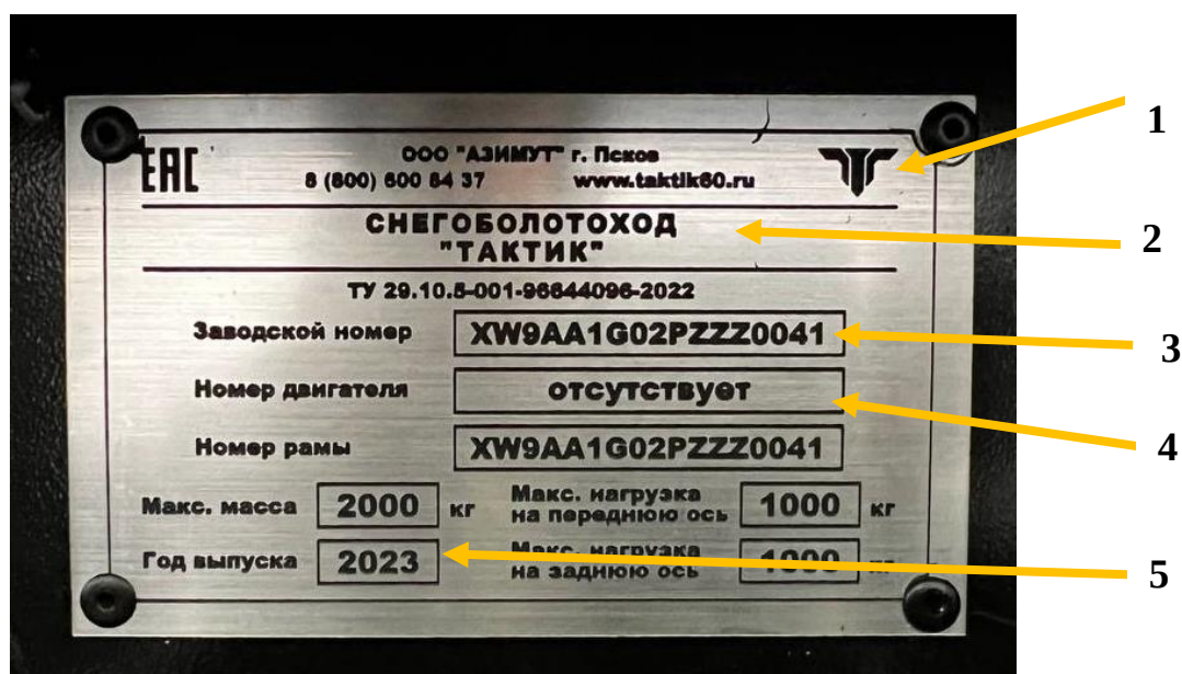
Рисунок 2 – Маркировка вездеходов «Тактик»
